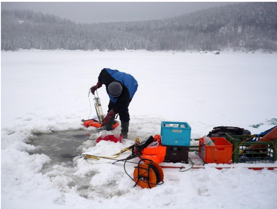
Odběr vzorků z ledu. Multiparametrická sonda pro měření fyzikálně-chemických parametrů vody na vertikálním profilu nádrže a zařízení pro odběr bodových vzorků vody a planktonu typu Friedinger. Josefův Důl, 2011. Foto: Luděk Rederer.
